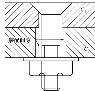
图 1 栓孔装配模型示意图
