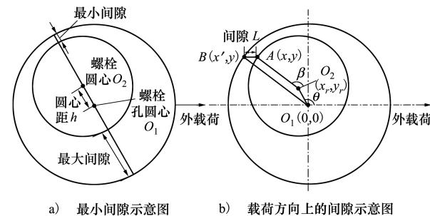
图 3 螺栓间隙示意图
