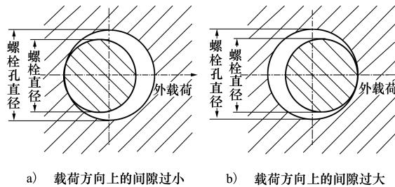
图 2 螺栓装配中的极限位置
