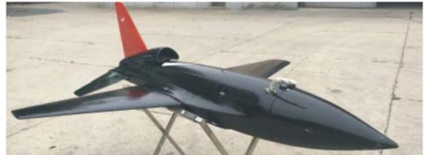
图 7 无人机涂覆吸波涂层后效果图
