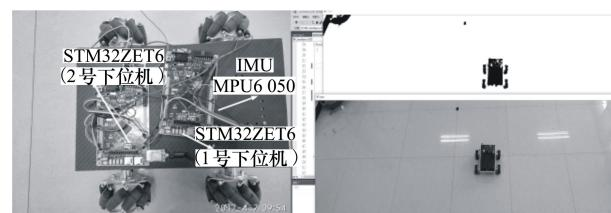
图 12 实验样机与软件
