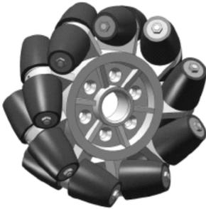
图 1 Mecanum 轮结构图
